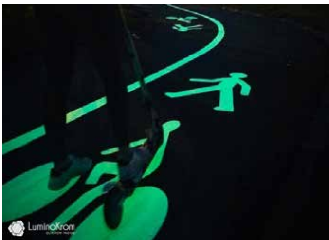
À Plouzané, Brest métropole expérimente le marquage au sol luminescent. Photo : Voirie Régie Signalisation Brest métropole
